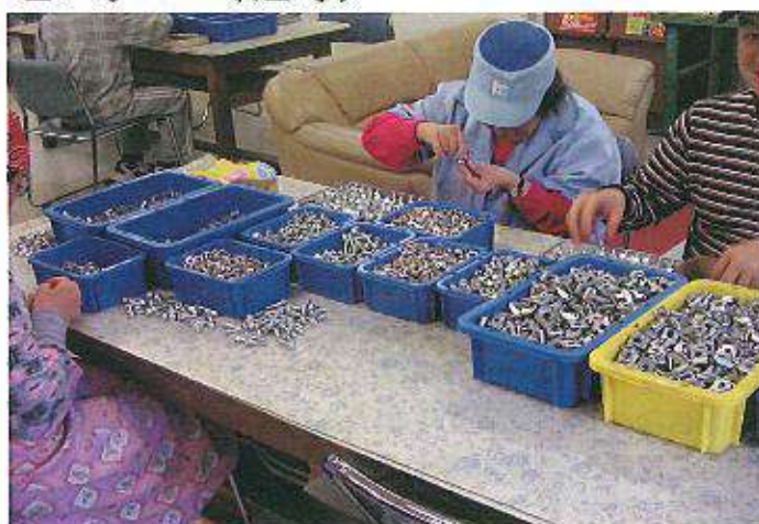
アースクランプ組み立て作業を行っているところです。
